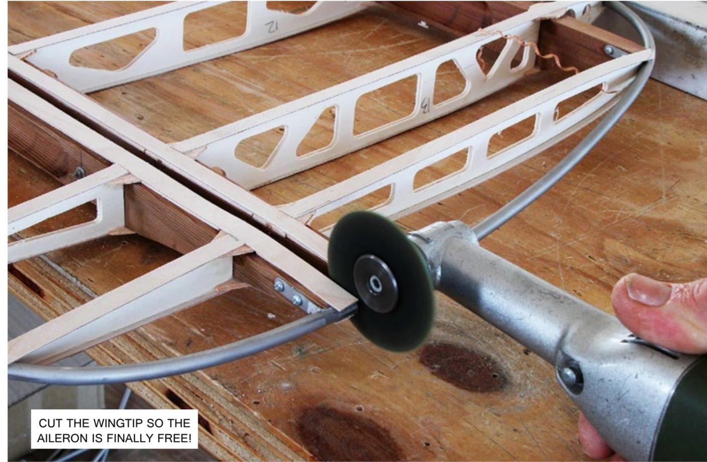
CUT THE WINGTIP SO THE ALERON IS FINALLY FREE!
