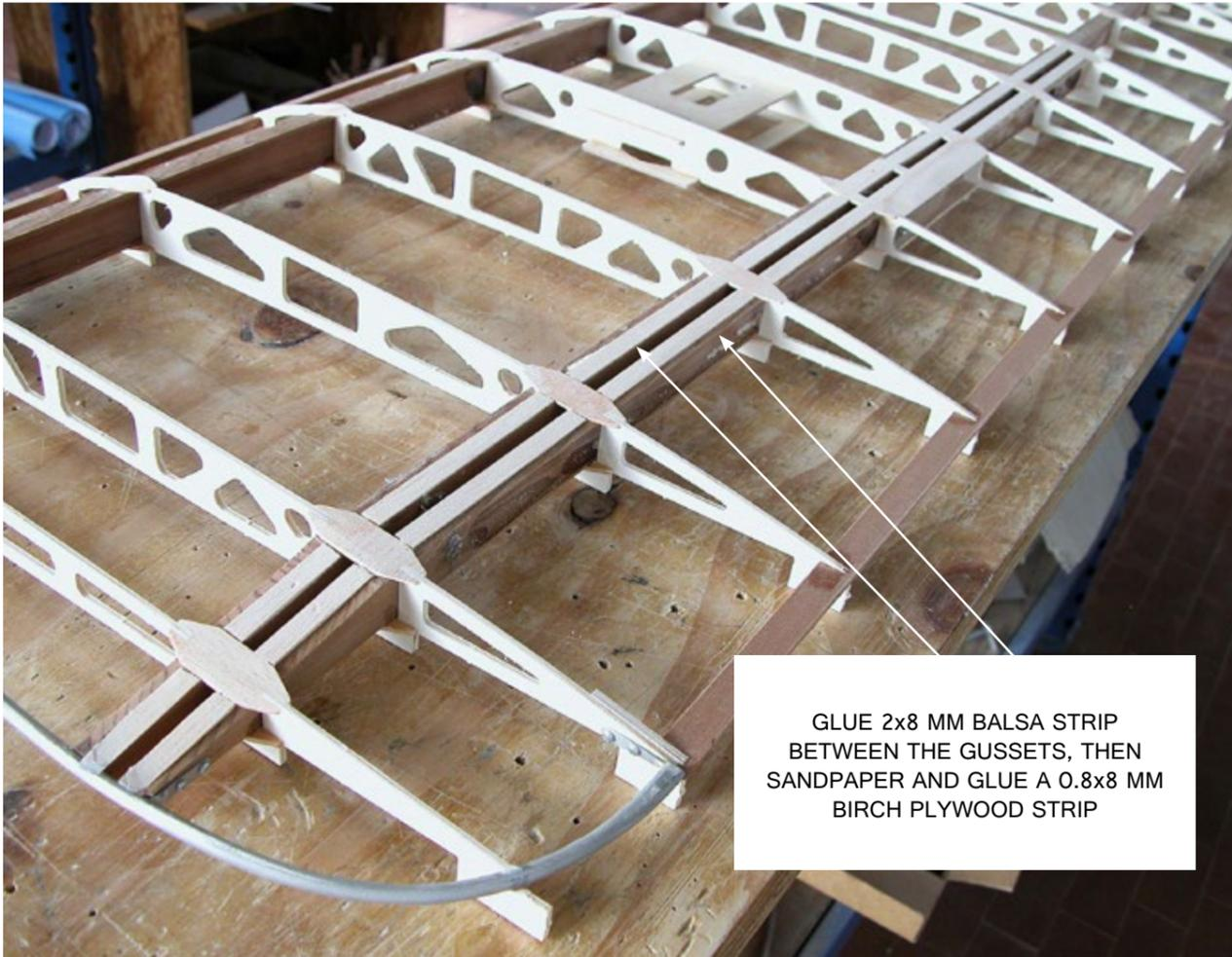
GLUE 2x8 MM Balsa STRIP BETWEEN THE GUSSETS, THEN SANDPAPER AND GLUE A 0.8x8 MM BIRCH PLYWOOD STRIP
