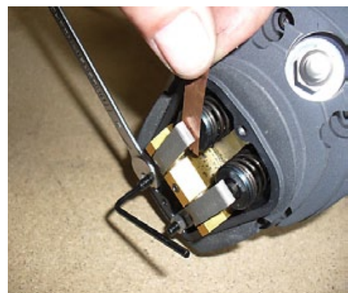
Die Bilderserie zeigt das Einstellen der Ventile mit Hilfe der Fühlerlehre.
